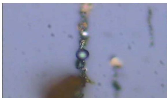
严重的疲劳磨损颗粒（数量大）
